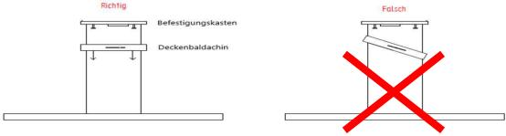
ACHTUNG: Den Deckenbaldachin beim Verschieben immer waagerecht und die Führungsseile immer leicht gespannt halten, damit diese nicht beschädigt werden.
