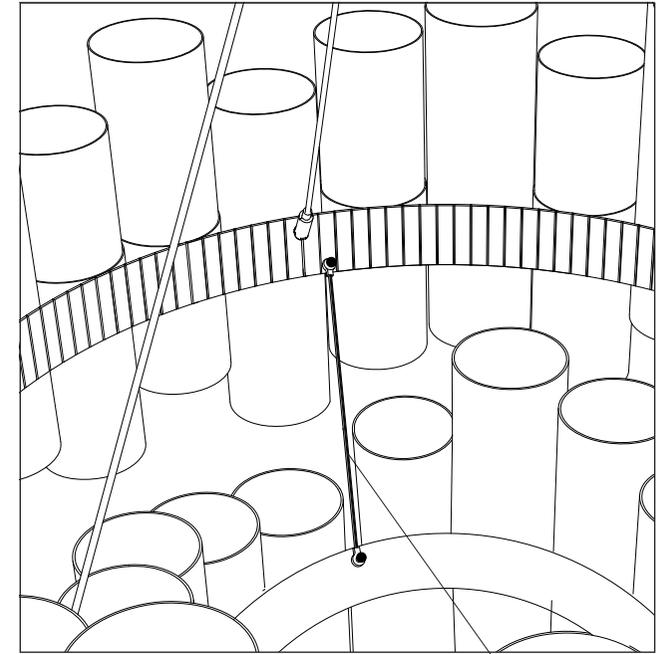
cavi supporto struttura / structural support wires
