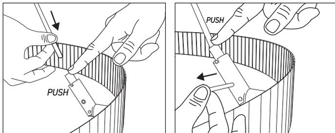
Inserire i cavi d'acciaio all'interno dei morsetti premendone la parte superiore. Per allungare o accorciare la lunghezza dei cavi d'acciaio premendo sulla parte superiore del morsetto .
