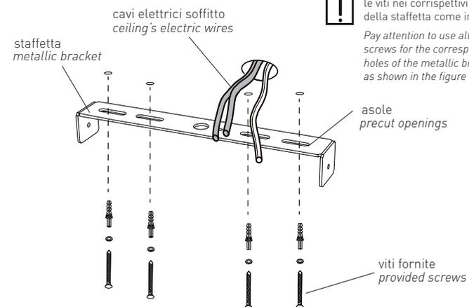
Forare il soffitto in due punti secondo le asole predisposte sulla staffetta e fissare quest'ultima con le viti fornite. Attenzione a non bloccare i cavi provenienti dal soffitto.
