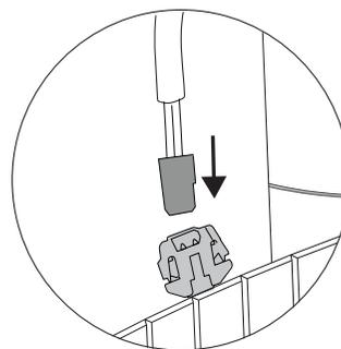
Collegare il cavo elettrico uscente dalla coppetta alla lampada tramite il morsetto come mostrato in figura.
