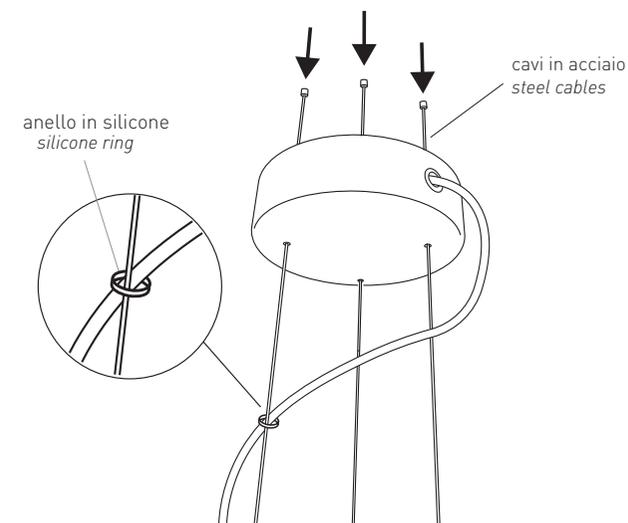
Inserire nella coppetta i 3 cavi d'acciaio forniti come mostrato in figura. Assicurarsi che uno dei 2 cavi d'acciaio passi all'interno degli anellini in silicone posti lungo il cavo elettrico.
