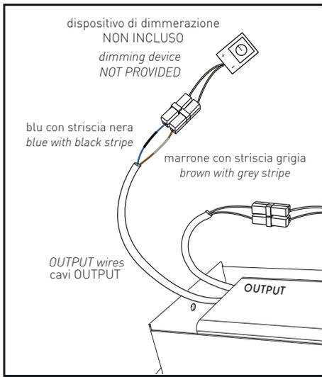
Se si desidera rendere la lampada dimmerabile, connettere il cavo bianco e il blu con i morsetti forniti al dispositivo di dimmerazione (non incluso) seguendo le **ISTRUZIONI DI ISTALLAZIONE DEL LED DRIVER** fornite. **Non usare un TRIAC DIMMER.**
